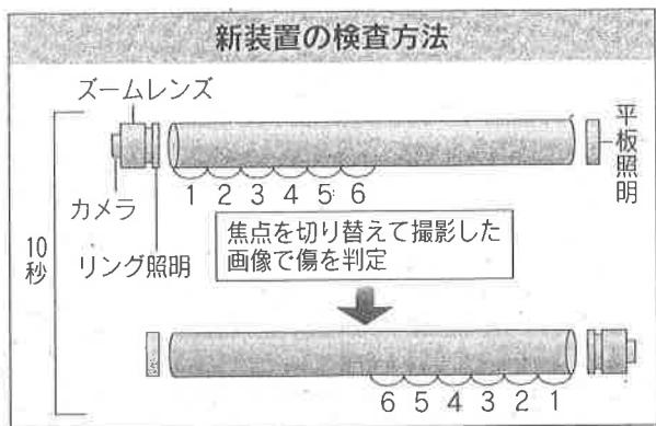
大学と連携し新事業開発を手掛けたアセット・ウィツツ(京都府)は、北陸先端科学技術大学院大学と共同で樹脂製や鋼管製などのパイプ内部を自動検査する装置を開発した。これまでには出荷前に人の目で傷の有無を確認していたが、独自開発のカメラで内部を複数回撮影して点検する。従来より作業効率が2倍以上に高まる。
